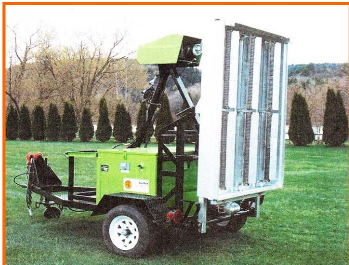
Инфракрасный асфальтовый нагреватель Tech-20 позволяет производить ямочный ремонт выбоин, восстановление покрытия после вскрытия инженерных коммуникаций, даже восстанавливать покрытия в холодную погоду эффективно и непрерывно. Создаваемое инфракрасное тепло проникает быстро и глубоко, размягчая внутренние слои асфальта без окисления или пережога. При подмешивании свежего горячего асфальта для
